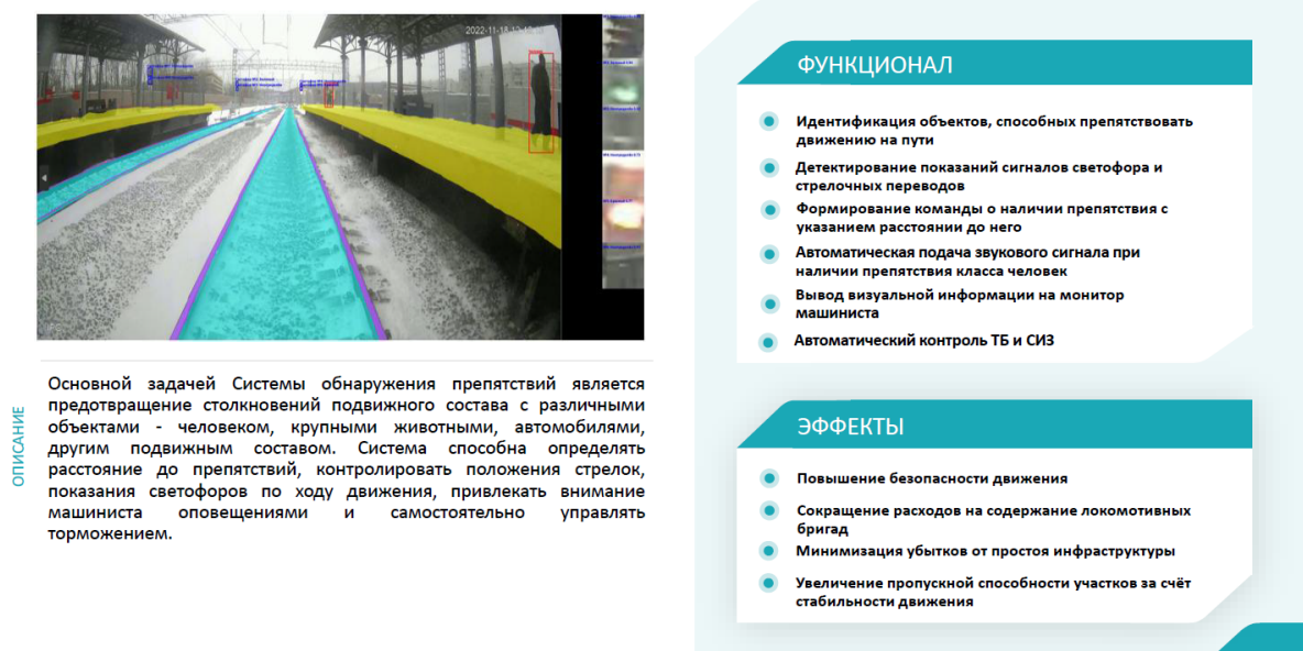
Рис. 16. Бортовая система обнаружения препятствий и дистанционного видеоконтроля (ООО «АВП Технология»)
