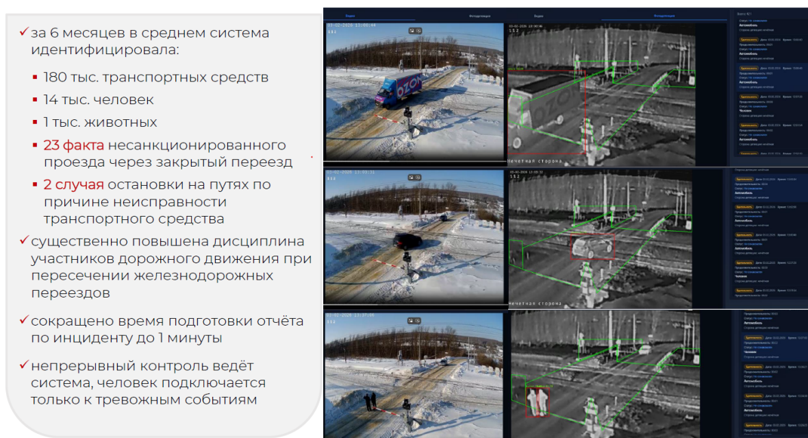
Рис. 15. Архитектура и результаты эксплуатации системы технического зрения на переезде (АО «ЭЛТЕЗА»)
