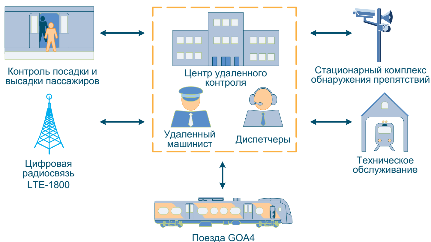
Рисунок 4. Архитектура беспилотной системы управления на МЦК
