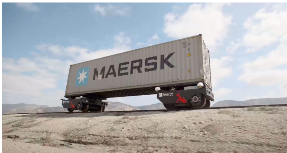
Рис. 1 – Моторные тележки Parallel для перемещения контейнеров [3]
