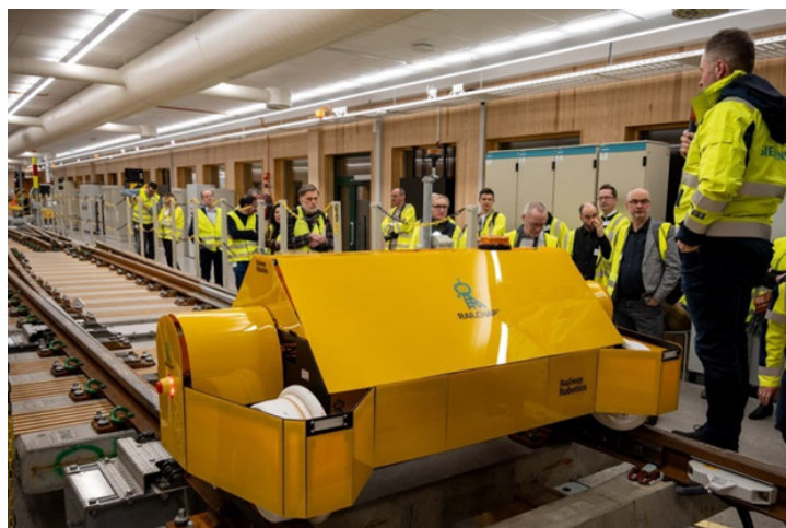
Рис. 4 – Робот Railchap предназначен для автономной диагностики и мониторинга критически важных элементов железнодорожной инфраструктуры, в первую очередь – стрелочных переводов
