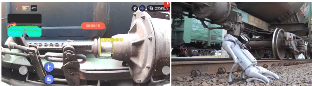
Рис. 11 – Исследовательские испытания экспериментального образца биоморфного робота, реализующего задачу обследования узлов грузового вагона
