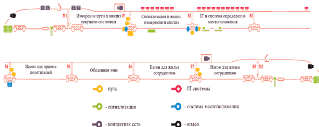
Рисунок 1. Схема расположения вагонов и датчиков «IRIS-320»
